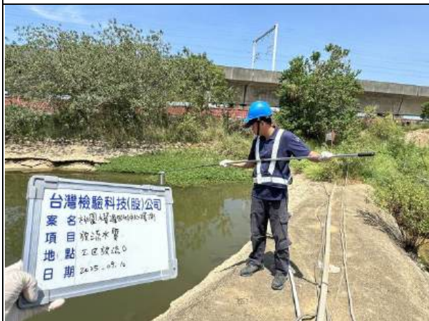
監測項目：放流水 監測地點：工區放流水 監測日期：114.09.10
