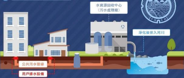
住戶每日排出的生活污水，經由密閉管線收集，從小管(家戶內的用戶管)→中管(巷道的分支管)→大管(大馬路的主幹管)輸送到水資源回收中心(污水處理廠)，淨化處理後再排入河川。這個由收集、輸送、處理設施所組成的系統，就是污水下水道系統，包括用戶排水設備、公共污水管綫及水資源回收中心。
