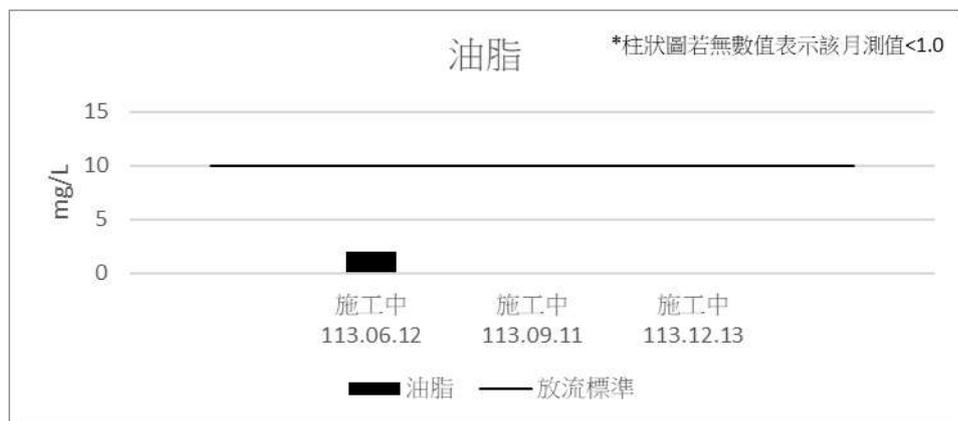
圖 2.4-5 放流水質監測結果(油脂)
