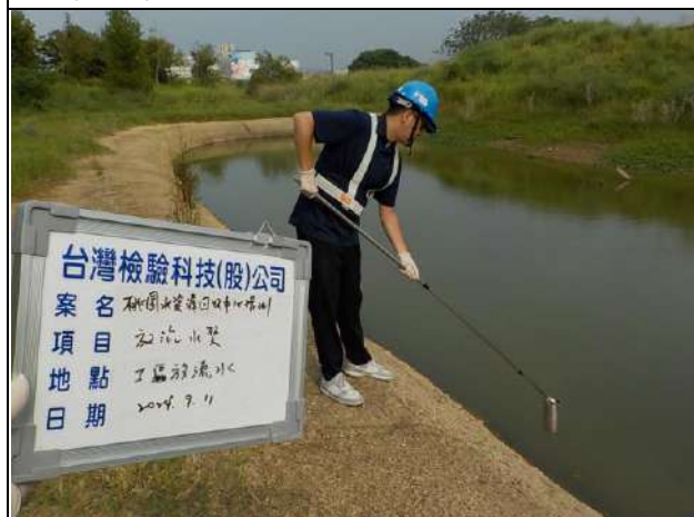
監測項目：放流水 監測地點：工區放流水 監測日期：113.09.11
